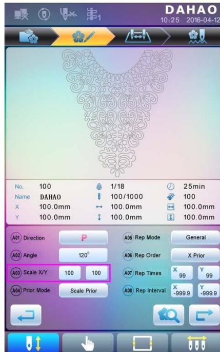
Sistema mostrará de forma independiente las ventanas de modificación para X Escala e Y escala para los usuarios configurar respectivamente.
